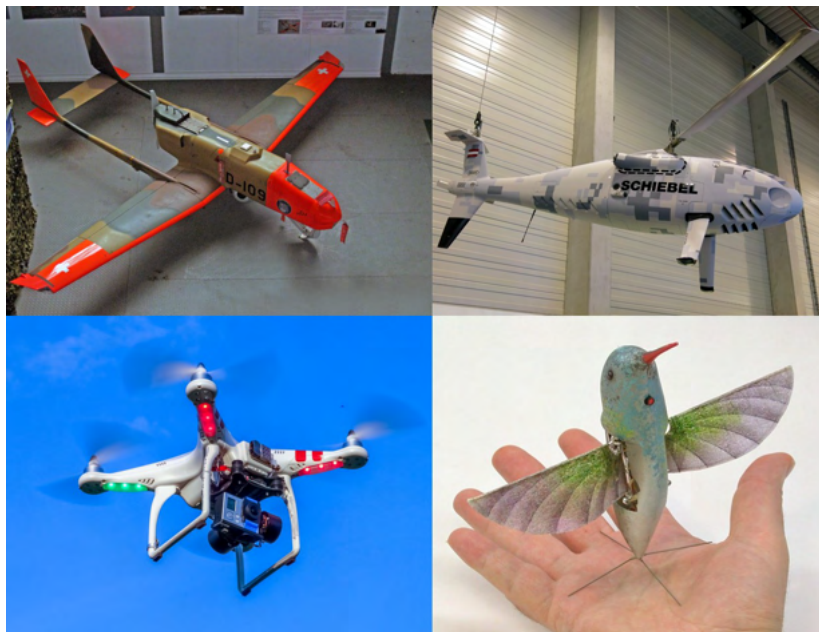
Abbildung 3.1: Bauformen anhand konkreter Beispiele, von links oben nach rechts unten: RUAG Ranger (ADS95), 27 Schiebel S-100 Camcopter, 28 DJI-Phantom 1 29 und Nano Hummingbird von AeroVironment, Inc. 30
